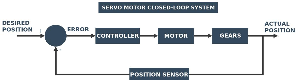
Ein Servomotor nimmt Spannung in Form von Impulsen (gewünschte Position) auf, die üblicherweise vom Mikrocontroller unter Verwendung von PWM (Pulsweitenmodulation) und Drehung der Abtriebswelle in die gewünschte Position erzeugt wird.
