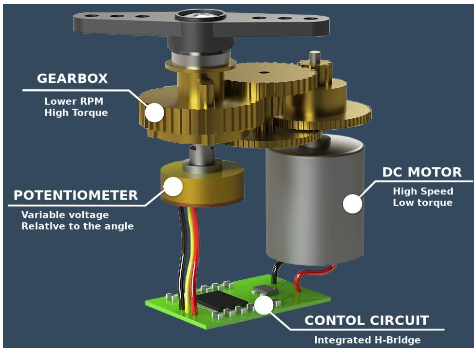
Ein Servomotor ist eine spezielle Vorrichtung, die einen Gleichstrommotor (hohe Drehzahl, niedriges Drehmoment), eine Rückführungselektronik (integrierte H-Brücke) mit Potentiometer und einen Satz Zahnräder enthält.
