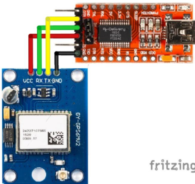
Im Anschluss daran musst du nur noch den Adapter mit deinem Rechner verbinden, die **Arduino IDE** starten, den richtigen Port wählen und das **Terminal** bei einer **Baud-Rate** von **9600** öffnen. Sobald das GPS-Modul mit Spannung versorgt wird, sucht es nach seiner Position und gibt diese über die **serielle Verbindung** weiter.
