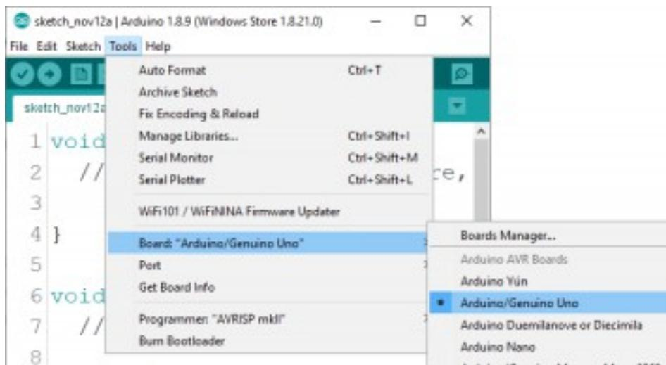
Der Port, an den die Mikrocontroller-Karte angeschlossen ist, muss ausgewählt werden. Gehen Sie zu: *Extras > Port > {Name des Ports steht hier}*
