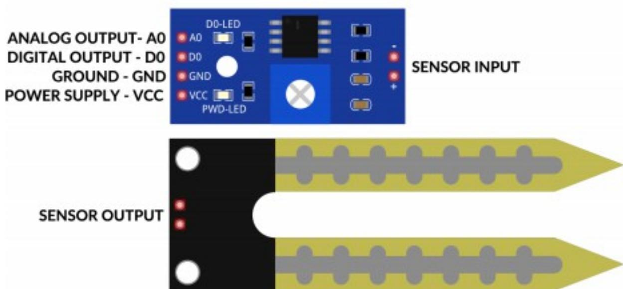
Die Sensorplatine hat keine Polarität, d.h. zwei Stifte der Sensorplatine können in beide Richtungen an die SENSOR INPUT Stifte der Steuerplatine angeschlossen werden.
